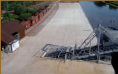
→ Déchargement de matériaux de construction sur une bande transporteuse intégrée au bateau
