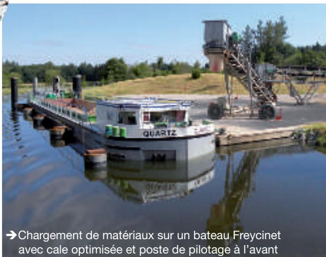
➔ Chargement de matériaux sur un bateau Freycinet avec cale optimisée et poste de pilotage à l'avant
