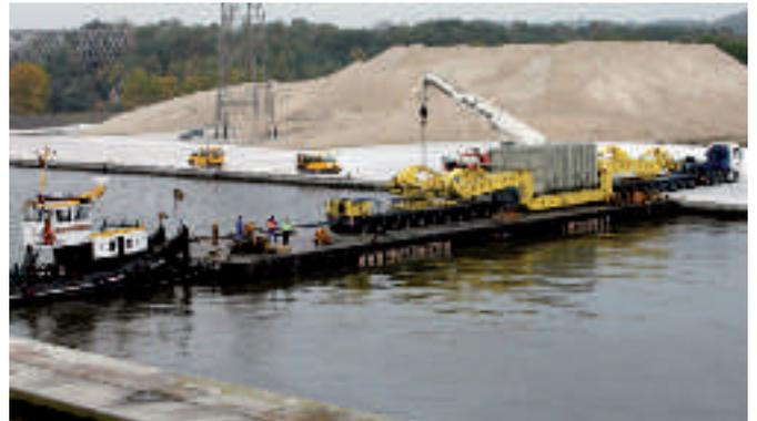
→ Chargement d'un transformateur électrique de 240 tonnes (4 m de large, 4,60 m de haut et 10,50 m de longueur)
